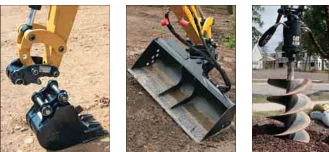
**Circuito idraulico ausiliario addizionale.** La versatilità della macchina nell'uso di attrezzi idraulici, è incrementato dalla possibilità di montare un secondo circuito idraulico ausiliario.
