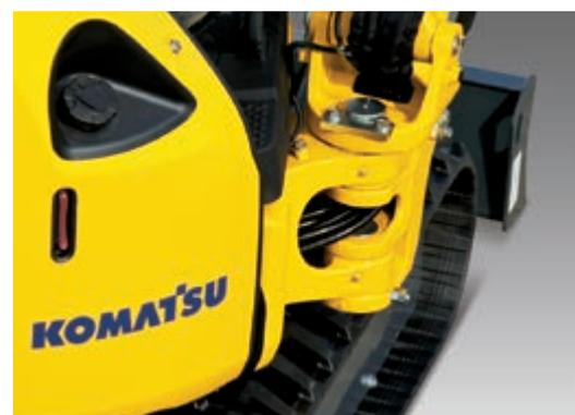
*Il cilindro di rotazione è ora riposizionato sul lato sinistro dell'escavatore per ridurre al minimo la sporgenza. L'operatore non deve preoccuparsi quando lavora vicino ad un muro.*
