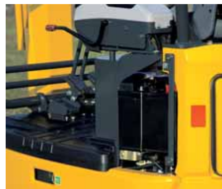
Cofano sinistro: accesso alla batteria
