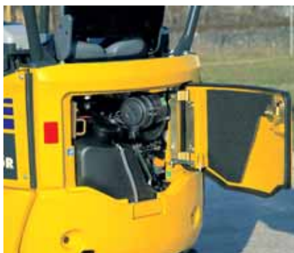
Cofano posteriore: controllo del motore e rifornimento carburante
