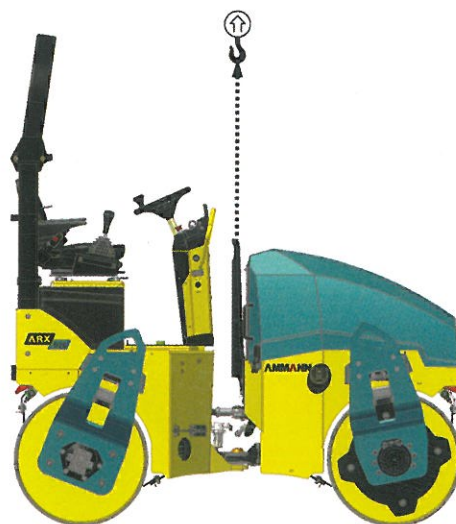
Punto di sollevamento centrale per gli ARX1 (standard) e ARX2 (opzionale)
