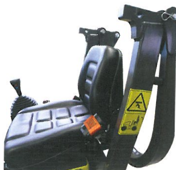
ROPS pieghevole per il trasporto facile
