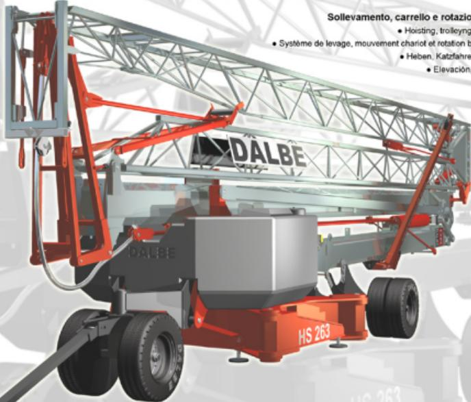
**Motori, finecorsa e limitatori nella parte bassa della gru: manutenzione e controllo a gru elevata.**
