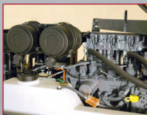
DOPPIO FILTRO E VISTA GENERALE DEL MOTORE Il doppio filtro garantisce una lunga durata anche in ambienti molto polverosi.
