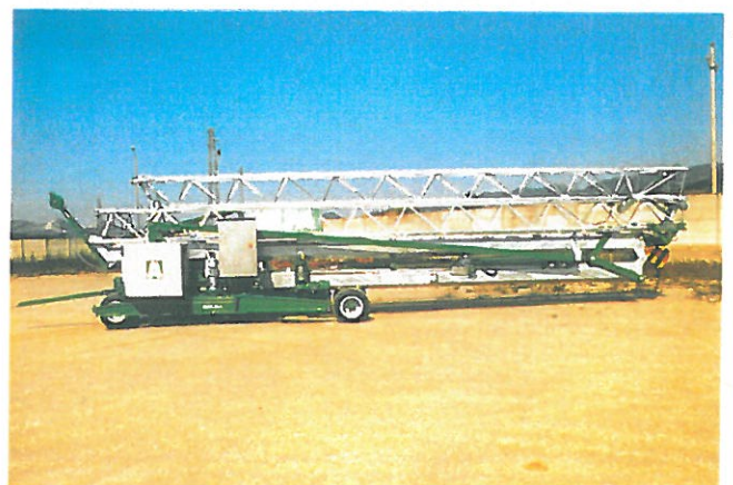
GRU IN ASSETTO DI TRAINO CON ZAVORRA DI MONTAGGIO CRANE READY FOR TOWING WITH ASSEMBLY BALLAST
