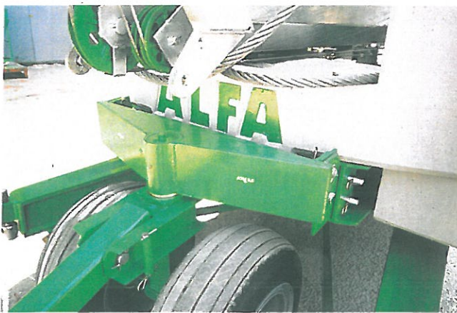
INNESTO ASSALE ANTERIORE CON ALTEZZA VARIABILE FRONT AXLE COUPLING WITH VARIABLE HEIGHT
