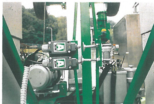
LIMITATORI DI MOMENTO IN BASSO (DPR 547 E CIRC. 77) MOMENT LIMITING DEVICES IN LOW POSITION (AS PER RULES)
