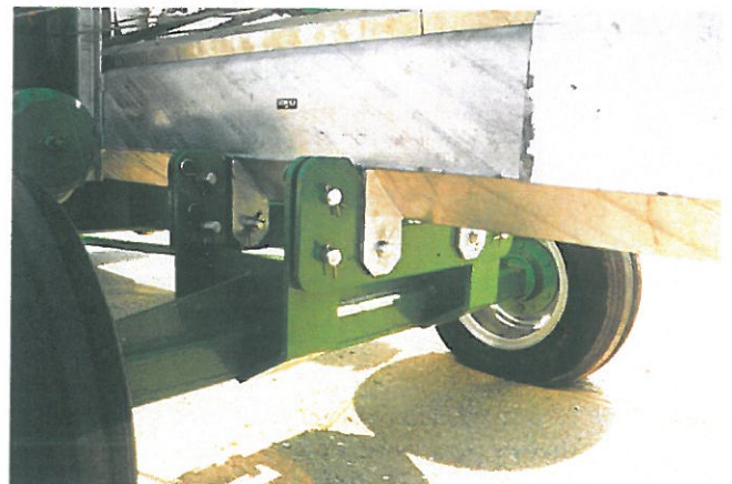
INNESTO ASSALE POSTERIORE CON ALTEZZA VARIABILE REAR AXLE COUPLING WITH VARIABLE HEIGHT
