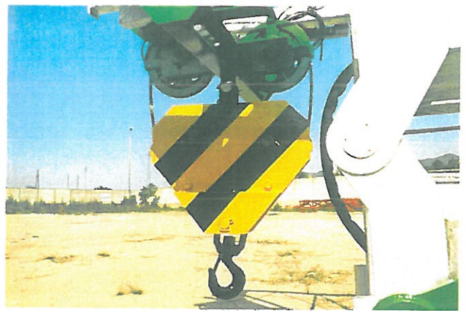
BOZZELLO DA KG. 1500 CON TIRO SEMPLICE HOOK BLOCK FOR KG. 1500 WITH 2/FALLS
