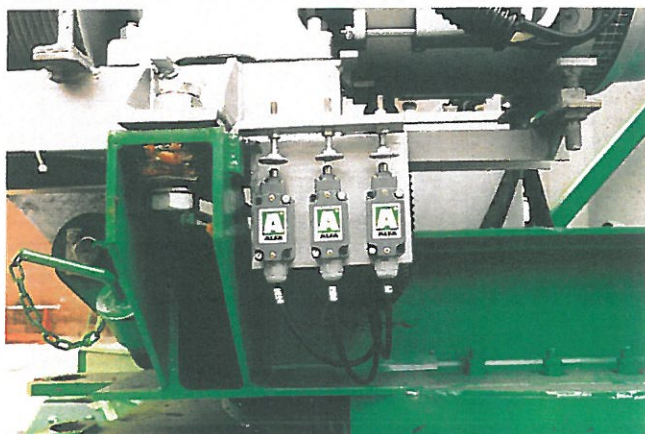
LIMITATORI DI CARICO IN BASSO (DPR 547 E CIRC. 77) LOAD LIMITING DEVICES IN LOW POSITION (AS PER RULES)
