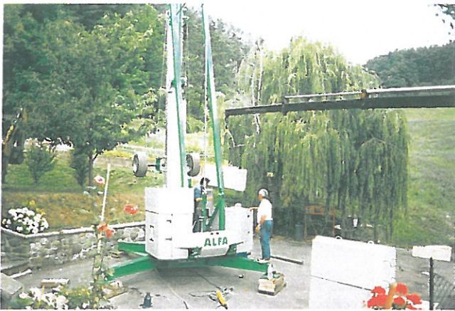
ZAVORRA MOBILE IN BLOCCHI DA KG. 1000 ADDITIONAL BALLAST - BLOCKS OF KG. 1000
