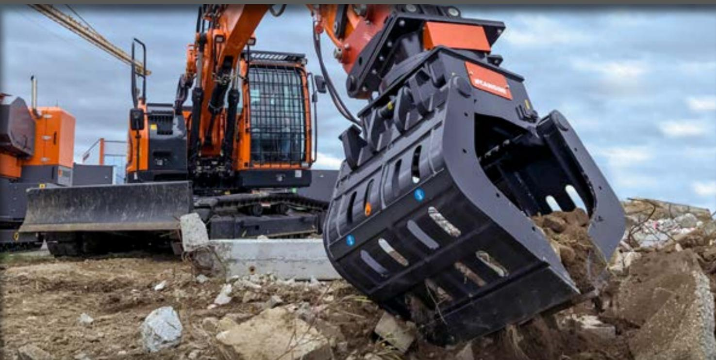
LA PINZA SELEZIONE MULTIUSO È PROGETTATA PER LA MOVIMENTAZIONE, IL RICICLAGGIO E ANCHE PER PICCOLE DEMOLIZIONI GRAZIE ALLA SUA STRUTTURA ROBUSTA. CONCEPITA PER MOVIMENTARE VARI MATERIALI IN MODO AFFIDABILE E SICURO. LA SUA MAGGIOR RESISTENZA È DATA DALLE SUE CHELE IN ACCIAIO ANTI USURA HB400. LA ROTAZIONE IDRAULICA A 360° DI SERIE GARANTISCE LA MASSIMA EFFICIENZA ED UN RISULTATO PRECISO.
