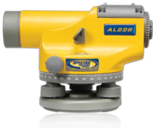
AL228. livello ottico automatico a 28 ingrandimenti. strumento semplice per eseguire lavori di livellamento in esterno. AL228 è dotato di un compensatore magnetico che permette di effettuare letture precise anche in presenza di vibrazioni.
